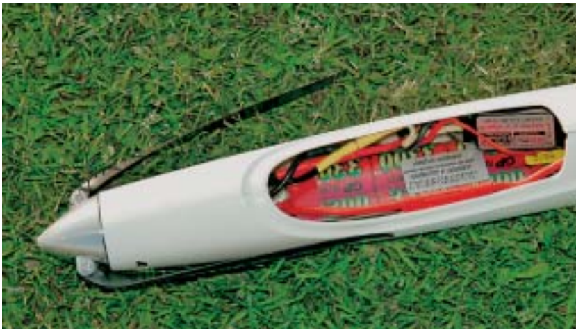
Innenbau: Eng geht's her, aber es reicht. Für die beiliegende Rutsche war allerdings kein Platz mehr. Gut zu sehen: der Akku stößt praktisch am Motor an.
