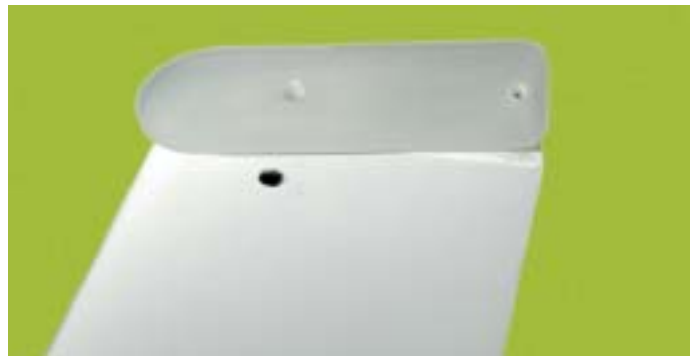
Die Höhenruderwippe wird mit einem Stahlstift gelagert. Damit sie sich frei bewegen kann, muss noch nachgearbeitet werden.
