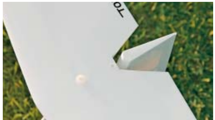
Das Seitenruder ragt etwas über das Höhenruder hinaus. Es muss noch etwas beschnitten werden, sonst lassen sich beide nicht frei bewegen.
