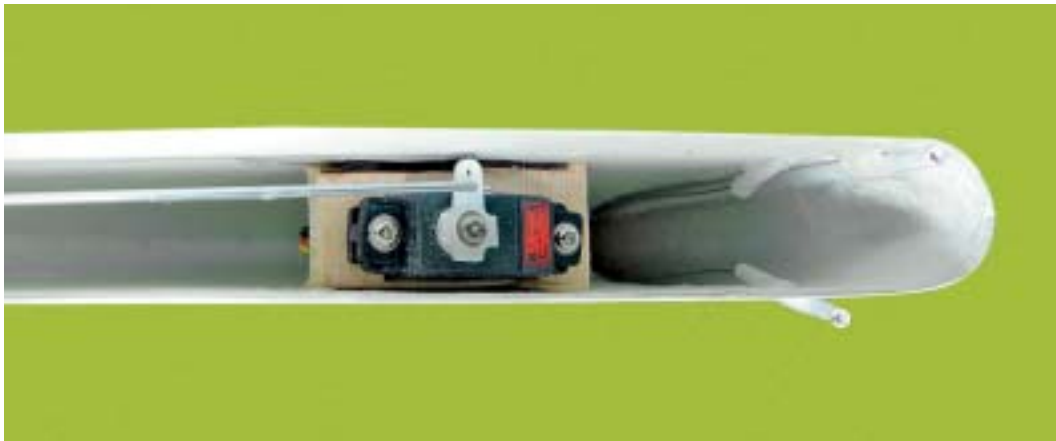
Der Einbau des Höhenruderservos ▲ erfolgt im Leitwerk
