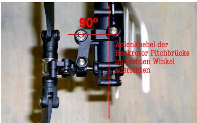
Nun wird das Servo entlang des Heckrohres verschoben, bis der Anlenkhebel der Heckrotor-Steuerbrücke rechtwinklig zum Heckrohr ausgerichtet ist. Wenn dies erreicht ist, Servo befestigen nicht vergessen.
