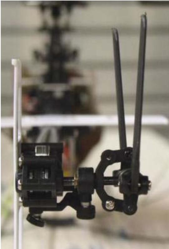
Zur einfachen Kontrolle richten wir den Heckrotor horizontal aus und klappen die beiden Heckrotorblätter nach oben.
