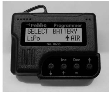
Die Bedienung des Programmiers ist denkbar einfach. Mit den äußeren Pfeil Tasten entweder nach unten oder nach oben springen um in den Programmier-Modi ihrer Wahl zu gelangen. Außerdem wechselt man mit ihnen den Modeltyp, indem man beide Pfeiltasten gedrückt hält. Die beiden mittleren Tasten DEC (-) und INC (+), dienen zur Auswahl bzw. zum Ändern einer Einstellung.
