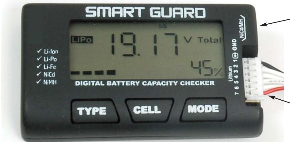
Connecter une batterie de type Ni-Cd ou Ni-Mh
