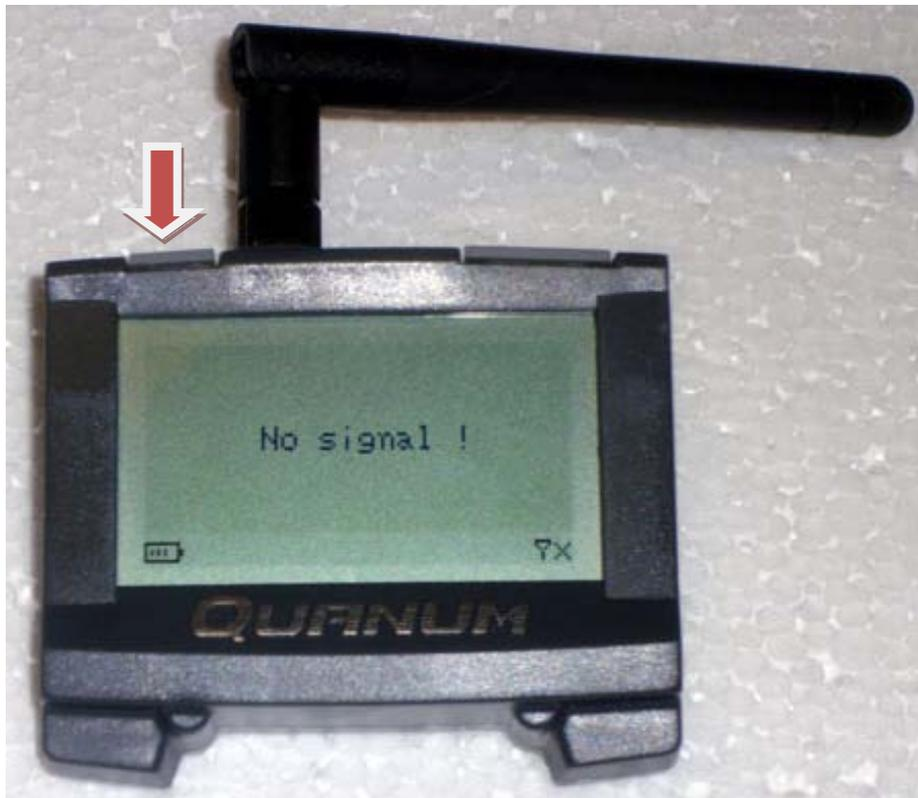
In diesem Fall den BIND-Button am Empfänger betätigen – nach kurzer Wartezeit (und angeschlossenem Akku am Sender) wird die Verbindung neu hergestellt und das System ist wieder betriebsbereit.
