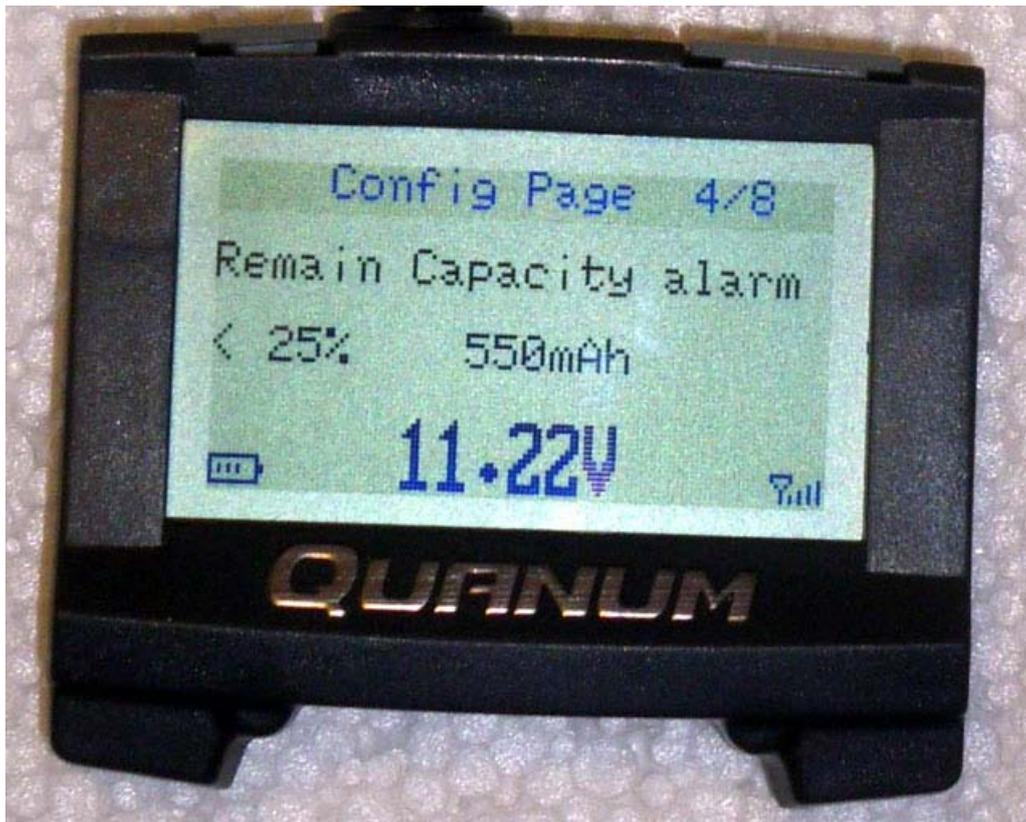
Hier wird der Schwellenwert zur Unterschreitung der Mindestkapazität eingestellt um eine Tiefentladung zu vermeiden. Üblicherweise sind hier Werte zwischen 20 und 25 % einzutragen.
