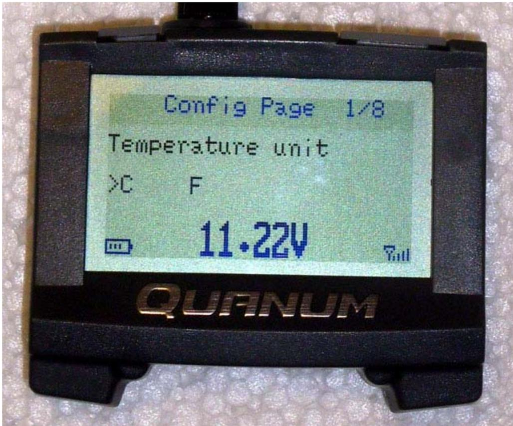
Hier kann für die Einheit für den Temperaturfühler (separates Add-on) eingestellt werden. Wahlweise Celsius oder Fahrenheit.
