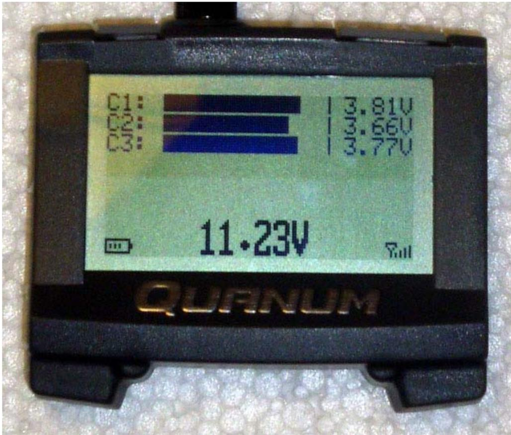
Vermutlich wird jetzt die Gesamtspannung blinken und alle 10 Sekunden eine Warntonfolge von 4 Piepsern hörbar sein.
