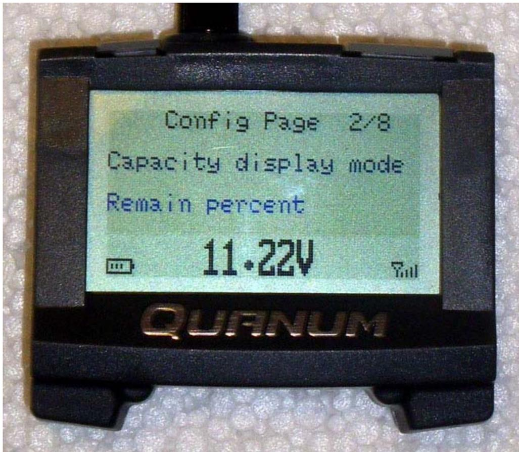
Auswahlmöglichkeit zwischen verbrauchter Spannung bzw. verbleibender Spannung
