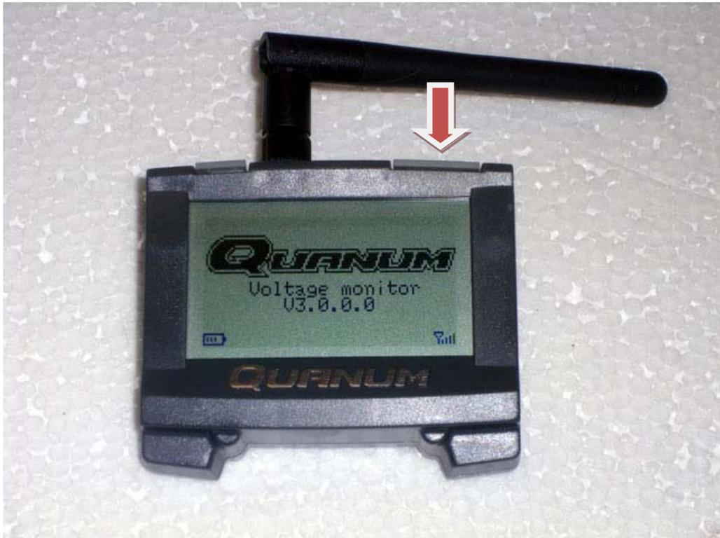
Halten Sie nun den BIND-Button am Sender gedrückt und stecken Sie den Balancer-Stecker des LiPo (2-6 Zellen) an. Achten Sie dabei auf die richtige Polarität gemäß Beschriftung!
