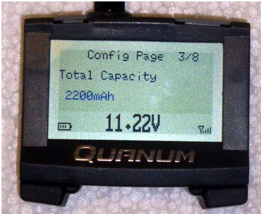
Für den ordnungsgemäßen Betrieb ist die korrekte Angabe der Akku-Kapazität unbedingt notwendig, da es sonst zu Fehlermeldungen kommt
